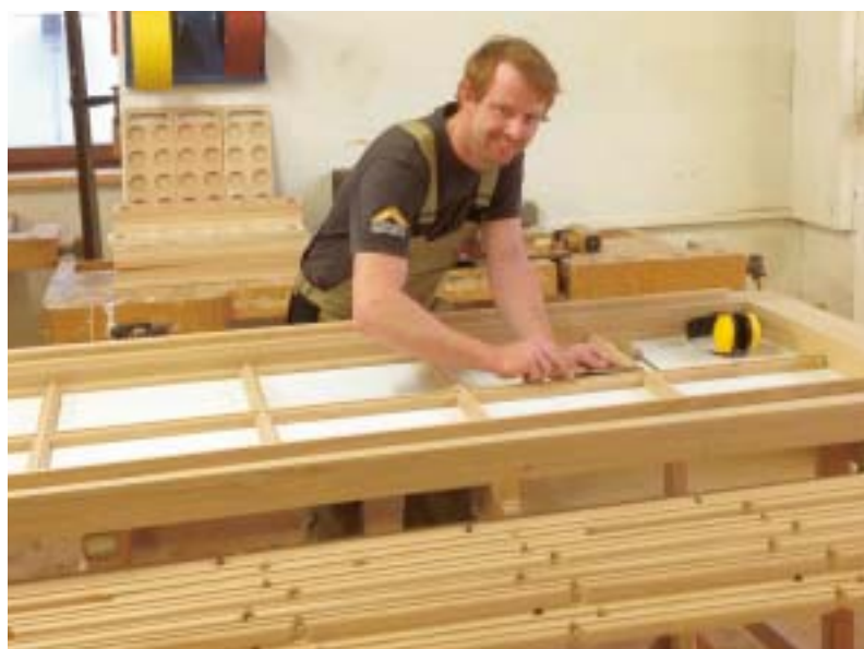
Brandschutz in Handarbeit: Fertigung der Maximilaneums-Türen bei Sedlmeyr
